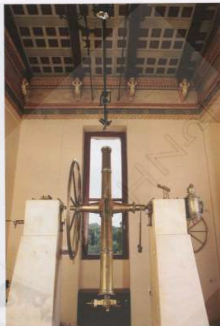
Εικ. 4. Το μεσημβρινό τηλεσκόπιο Starke, που βρίσκεται στην ανατολική αίθουσα του κτηρίου Σίνα.
