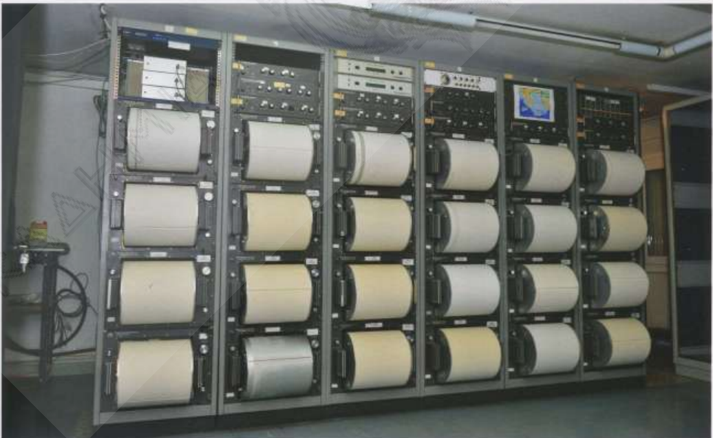
Εικ. 32. Καταγραφικά τύμπανα Αναλογικών Σεισμογραφικών Σταθμών του Εθνικού Σεισμογραφικού Δικτύου (Ε.Α.Α.-Γ.Ι.).
