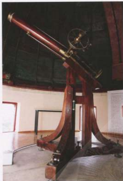
Εικ. 3. Διαθλαστικό ισημερινό τηλεσκόπιο Ploessl στον θόλο του κτηρίου Σίνα.
