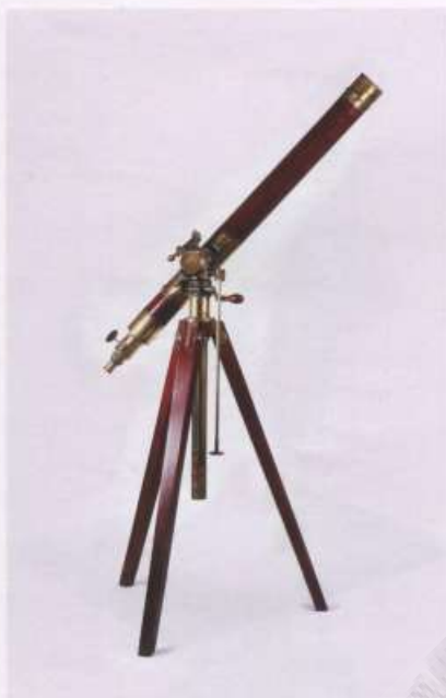
Εικ. 7. Διοπτρικό ισημερινό τηλεσκόπιο Jacob Merz 80 mm.
