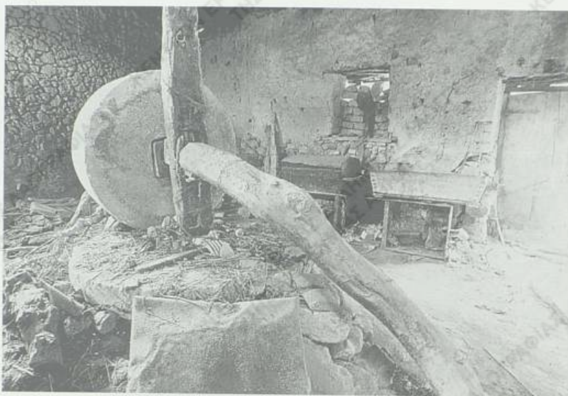
Εικ. 3. Εσωτερικό ιπποκίνητου ελαιοτριβείου (Βουνάρια Μεσσηνίας, 1998).
