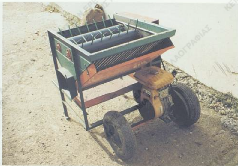
Εικ. 15. Μηχανοκίνητος «γάιδαρος» για την ελαιosuλλογή. (Πετρίνα 1998, Φ. Α. ΠΤΙ. ΕΤΒΑ, φωτ. Π. Μπαγετάκου).
