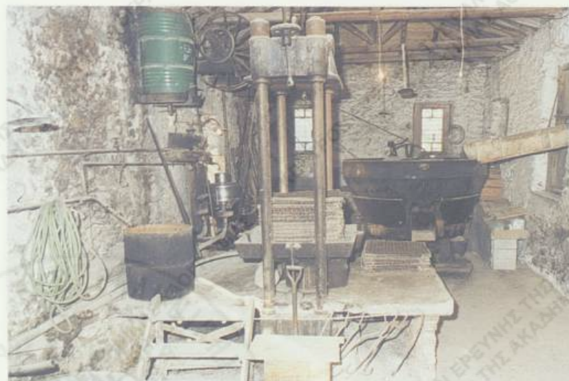
Εικ. 10. Χειροκίνητη πρέσσα λαδιού με βίντσι (Άγιος Νικόλαος, Μάνη 1999, Φ. Α. ΠΤΙ. ΕΤΒΑ, φωτ. Π. Μπαγετάκου).
