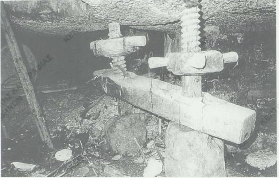
Εικ.7. Σωζόμενες ξύλινες βίδες, σφικτήρες σύνθλιψης ελαιοζύμης.
